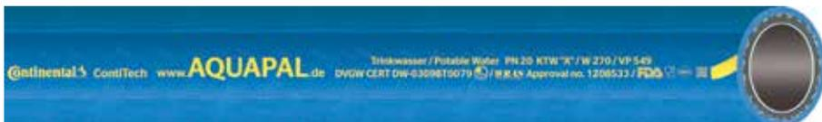
Hochflexibler Qualitäts-Trinkwasserschlauch mit spezieller transparenter, plastomerer und weichmacherfreier Innenschicht, welche homogen, glatt und absolut geruchs- und geschmacksneutral ist. Der Druckträger aus PES sorgt für hohe Druckbeständigkeit, während die NBR-Außenschicht ihm Resistenz gegen Abrieb, Fette, Öle, UV-Strahlung, Ozon und gebräuchliche Reinigungs- und Desinfektionsmittel verleiht.
