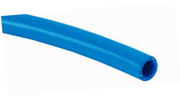
Robuster Trinkwasserschlauch, der die Anforderungen gemäß KTW A (Kaltwasser bis 23°C und Warmwasser bis 60°C) und die technischen Regeln des DVGW W270 und VP549 erfüllt (geprüft). Der Schlauch aus PE (Polyethylen) mit dreischichtigem Aufbau und Polyesterfadeneinlage ist innen transparent und außen blau. Ausgestattet mit hervorragenden mechanischen Eigenschaften speziell für den Außeneinsatz: Druckbeständig, abriebfest, witterungs- und UV-beständig sowie überfahrbar.
